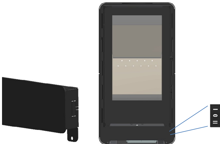
Figura 39 - Fixação do switch na tampa frontal
